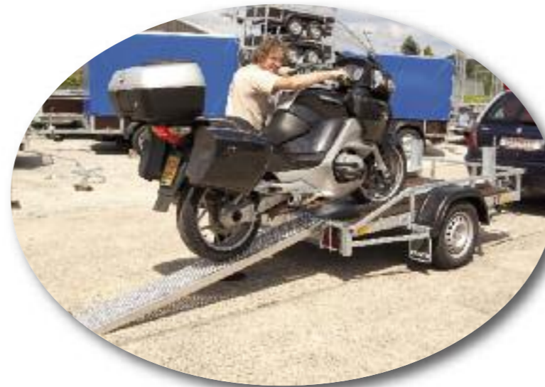
Large rail antidérapant pour une grande facilité de chargement
