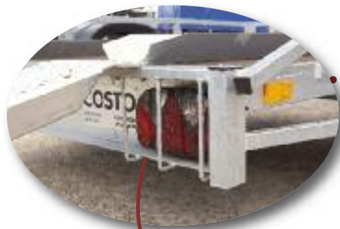
Feux encastrés protégés par une tôle d'acier de 3 mm et un grillage
