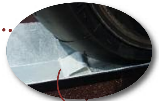
Le pneu avant est stabilisé dans le support... ..et retenu par la cale qui l'empêche de reculer
