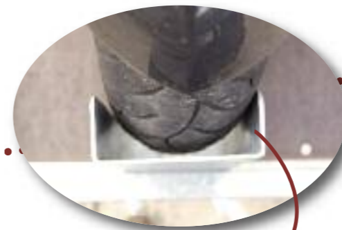
Le pneu avant est stabilisé dans le support... ..et retenu par la cale qui l'empêche de reculer
