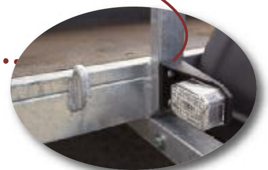
Feux blancs avec catadioptré montés sur pattes flexibles
