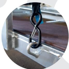
• Crochets d'arrimage fermés placés à des endroits étudiés et testés, pas de risque de décrochage
